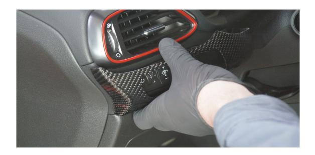
Die Rückseitige rote Schutzfolie des Klebers entfernen. Das Cover ohne Druck in Position bringen. Sind Sie sich sicher das dass Cover perfekt sitzt mit festem Druck auf das originale Teil pressen.
