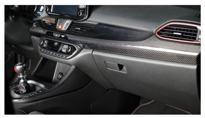
Bei der großen Leiste entfernen Sie auch die Rückseitige Schutzfolie des Klebers. Danach das Cover vorsichtig und ohne Druck in Position bringen. Wichtig Bitte von links nach rechts arbeiten. Nie Links und Rechts gleichzeitig anlegen. Es kann sonst zu Wölbungen im Bereich der Lüftung kommen.
