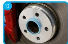
Prüfen Sie die neuen Befestigungsmittel auf passende Länge und Typ (vgl. Schraubenhinweise in dieser Montageanleitung). Bei Radschrauben muss die Schaftlänge um die Dicke der Spurverbreiterung länger sein als bei den ursprünglichen Radschrauben. Bei Radmutter muss die gewindenspezifische Mindestschräubtiefe weiterhin gegeben sein (siehe Schraubenhinweise).
