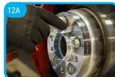
Montieren Sie die Spurverbreiterung mit den mitgelieferten Befestigungsmitteln an der Radnabe und ziehen Sie diese handfest an. Install the wheel spacer onto the wheel hub using the supplied fastening elements and tighten them lightly by hand.
