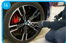
Ziehen Sie die Befestigungselemente in mindestens zwei Durchgängen kreuzweise an. Prüfen Sie dabei auch zweimal, ob das Drehmoment korrekt ist. Tighten the fastening elements in at least two stages in a crisscross pattern. Check twice to ensure that the torque is correctly set.
