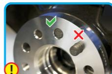
Stecken Sie die Serienradschraube in die Felge und messen Sie die Länge, die aus der Felge herausragt. Diese Länge muss kleiner sein als die Dicke der Spurverbreiterung. Andernfalls ist die Serienradschraube zu kürzen oder durch eine passende Schraube zu ersetzen.
