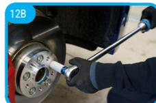
Ziehen Sie die Befestigungselemente in mindestens zwei Durchgängen kreuzweise an. Nur die mitgelieferten Befestigungselemente verwenden. Drehmomentschlüssel auf korrekten Wert einstellen. Siehe dazu die Vorgaben des Fahrzeug- bzw. Felgenherstellers. Tighten the fastening elements in at least two stages in a crisscross pattern. Only use the supplied fastening elements. Set the torque wrench to the correct value according to the manufacturer's specifications.
