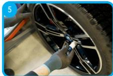
Entfernen Sie die Radbefestigungsteile (5) und nehmen Sie das Rad ab (6).
