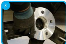
Prüfen Sie, ob die Außenfase und der Zentrierbund der Spurverbreiterung spielfrei an der Innenfase der Nabenlochanbohrung und plan an der Anlagefläche Ihrer Felge anliegen. Check whether the outer chamfer and centering collar of the wheel spacer fit snugly against the inner chamfer of the hub bore and sit flush against the contact surface of your rim.
