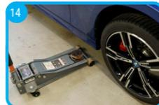
Entfernen Sie den Unterstellblock und lassen Sie den Wagenheber langsam ab. Remove the jack stand and slowly lower the vehicle using the jack.
