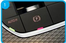
Sichern Sie das Fahrzeug durch Betätigung der Feststellbremse und ggf. der Verwendung eines Sicherungskeils gegen das Wegrollen.
