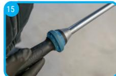
Stellen Sie den Drehmomentenschlüssel auf den korrekten Wert ein. Siehe dazu die Vorgaben des Fahrzeug- bzw. Felgenherstellers. Set the torque wrench to the correct value. Refer to the specifications of the vehicle or wheel manufacturer.
