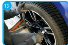
Legen Sie das Rad an und montieren Sie die neuen Befestigungsmittel von Hand. Ziehen Sie diese handfest an. Position the wheel back, place the new fastening elements and tighten by hand.
