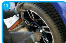
Legen Sie das Rad an und montieren Sie die originalen Befestigungsmittel von Hand. Ziehen Sie diese handfest an. Position the wheel and install the original fastening elements by hand. Tighten them lightly by hand.
