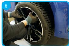
Befreien Sie die Anlagefläche und Mittenzentrierung des Fahrzeugs vorsichtig mit einer Drahtbürste von Schmutz und Rost. Carefully clean the contact surface and center bore of the vehicle using a wire brush to remove dirt and rust.
