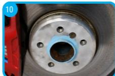
Tragen Sie die Korrosionsschutzpaste dünn im Bereich der Mittenzentrierung an der Achsanlagefläche auf. Apply a thin layer of corrosion protection paste to the center bore area of the vehicle.
